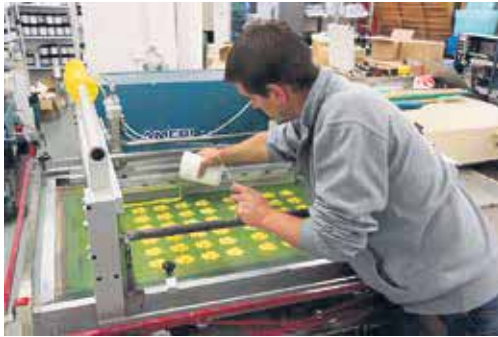
Der Siebdruck beruht auf dem Prinzip einer Schablone (Sieb). Im Druck wird jede Farbe mit einem Rakel (Gummirakel) durch die Maschen eines feinen Gewebes gedrückt, was eine gleichmässige und stabile Farbfläche ergibt. Hier wird gerade die grüne Watterfarbe aufs Sieb gegossen.
